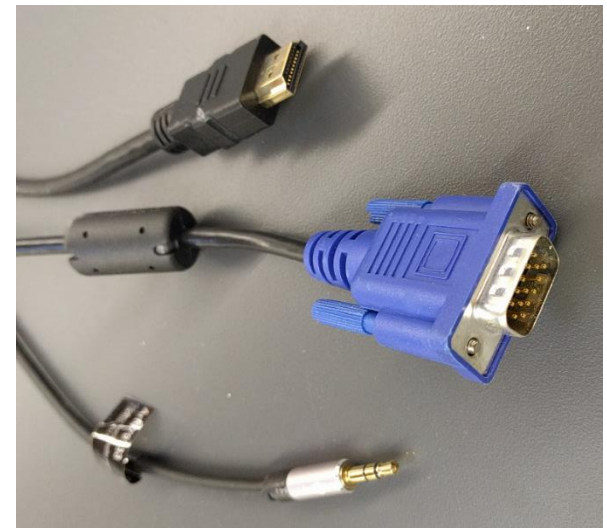
Anschlüsse VGA, HDMI und Audioklinke
