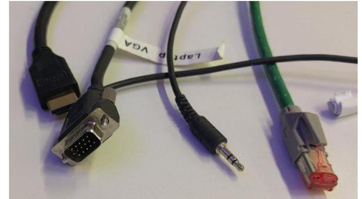
Anschlüsse für Recording mit Video/Aufnahmeleuchte und extern Audio
