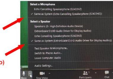
Unter **Select a Speaker** wählen Sie mit der Standardeinstellung **Same as System** oder **Extron ScalerD (HD Audio Driver for Display Audio)** die **Saallautsprecher** aus.
