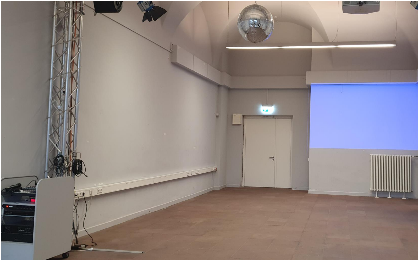
Raumansicht nach vorne. Rechts Projektionsfläche, links Audioschrank sowie Anschlusskabel HDMI zum Beamer und Miniklinke für Audio
