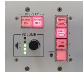
**Projektion:** Einschalten mit der Taste **BEAMER ON**, ausschalten mit **BEAMER OFF**.
