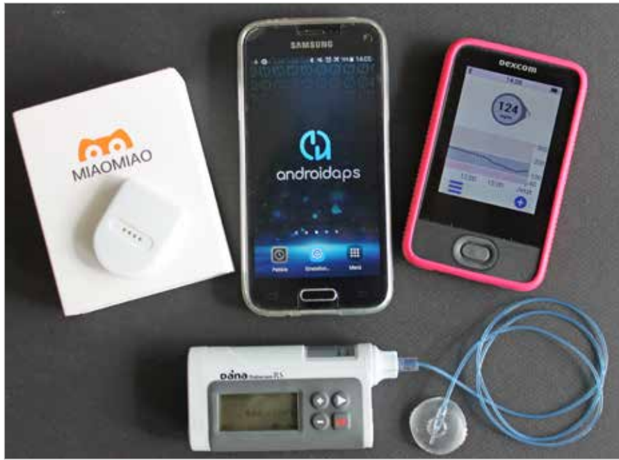
Komponenten eines Open-Source-Closed-Loop-Systems des CS Projektes „TeQfor1“. Foto: TeQfor1/KIT
